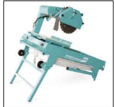
Con patas plegables y con ruedas para facilitar su movimentación manual y la carga sobre el vehículo. Transportable por una sola persona.
