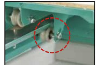
Con guías para el carro en acero inoxidable. Bomba de agua protegida para sedimentos. Higiénica cubete de plástico desmontable para su limpieza, con decantación para atrapar los sedimentos.
